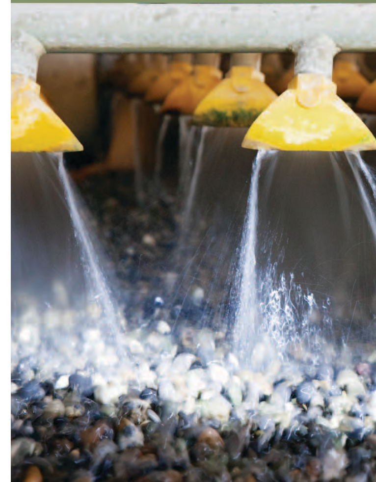
Ein Gemisch aus Sand und Kies ist die Grundlage für Beton. Das Wasser zum Waschen des Rohmaterials wird in einer Wiederaufbereitungsanlage gesäubert und in den natürlichen Kreislauf zurückgegeben. So lässt sich der Wasserverbrauch minimieren.
