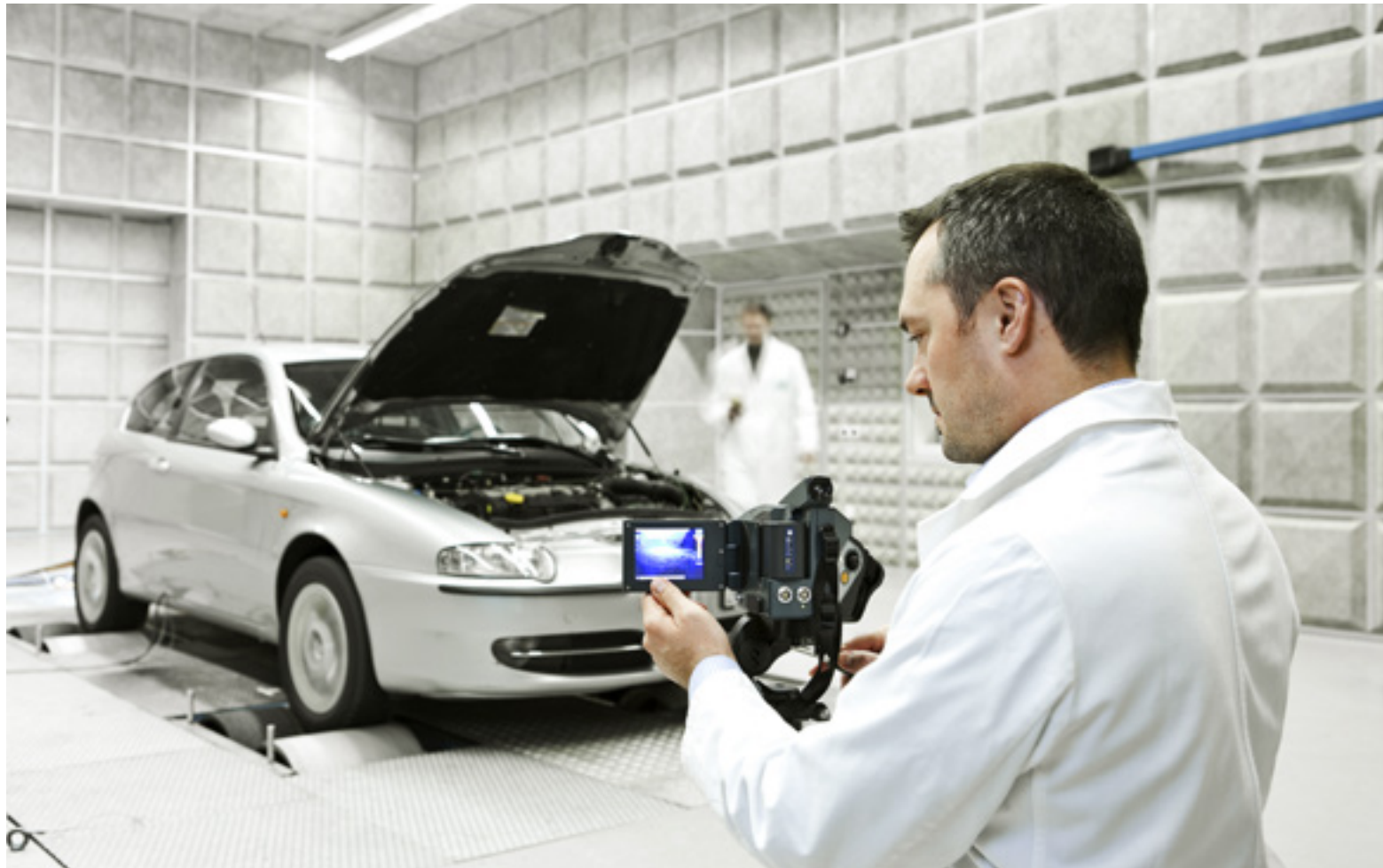
Analyse thermique du dessous de caisse avec caméra infrarouge.
