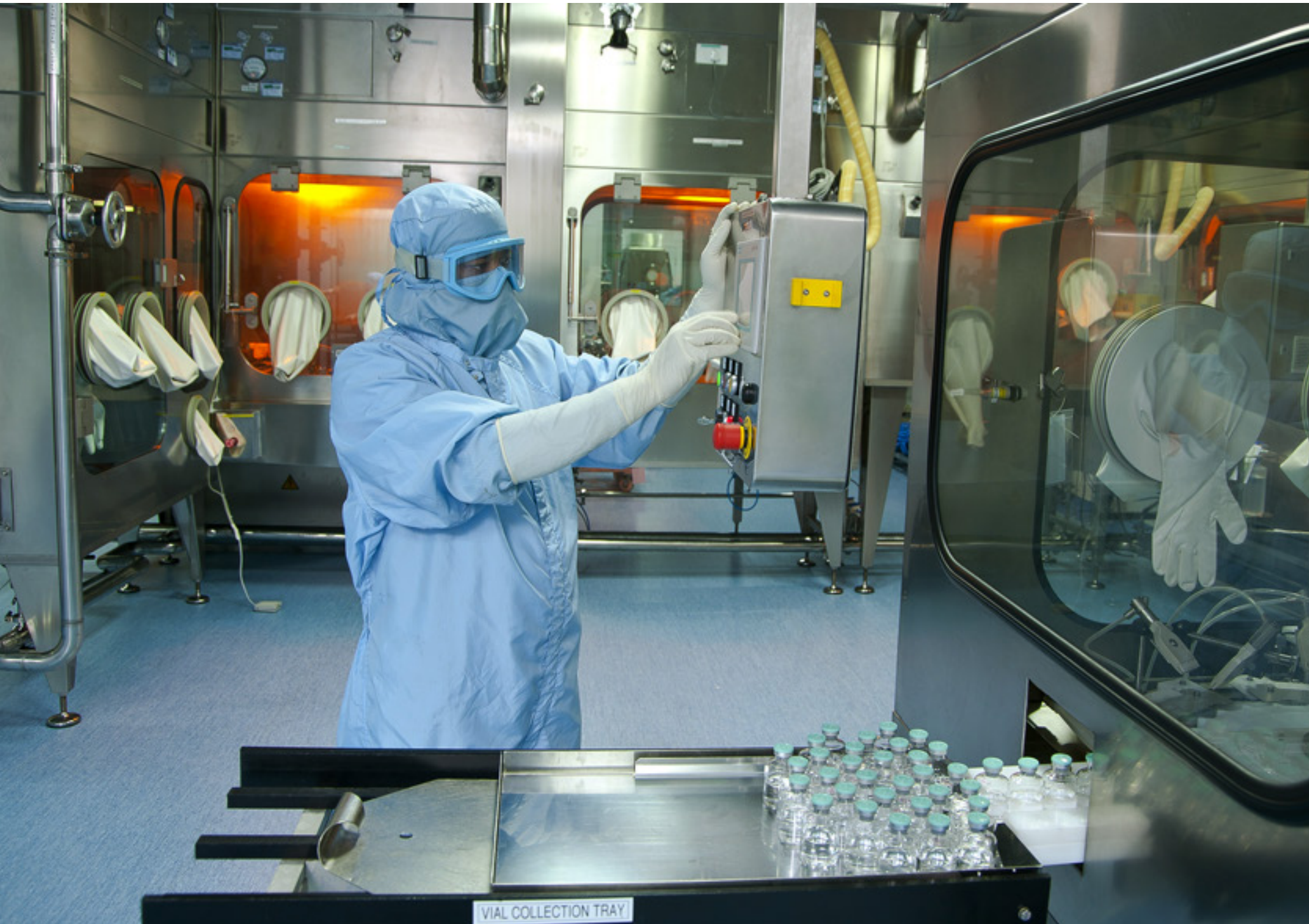
Ligne de remplissage aseptique intégrée avec système isolateur barrière dans l'installation de remplissage des injectables de Dr. Reddy's.
