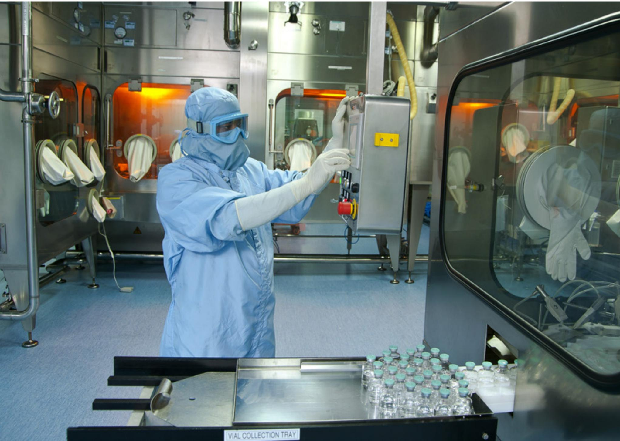
Integrierte aseptische Abfüllung mit Isolatortechnologie in der Abfüllanlage für Injektionssysteme von Dr.Reddy's.
